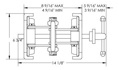
MODEL NUMBER IS SMS-09-V46-QIT-4 FITS BEAM FLANGE WIDTH OF 3" TO 7 1/2" HEADROOM IS 10"
