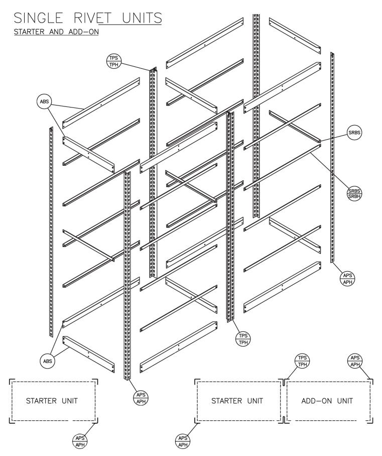
NOTE: FRONT-TO-BACK SINGLE RIVET BEAM IS LOCATED AT ONE INTERMEDIATE LEVEL ONLY. THE ABOVE EXAMPLE INCLUDE THREE (3) FRONT-TO-BACK SINGLE RIVET BEAMS.
